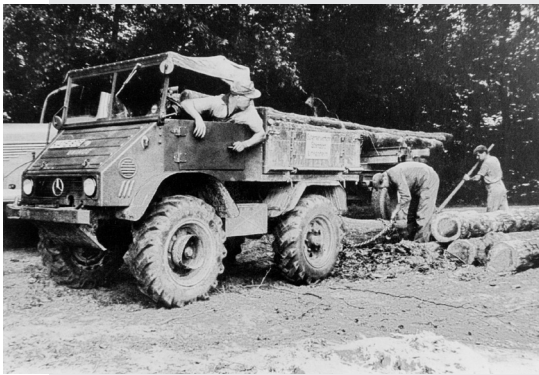
Unimog, der die Baumstämme aus dem Wald schleift und mit einem Spezialanhänger zum Lagerplatz transportiert.
